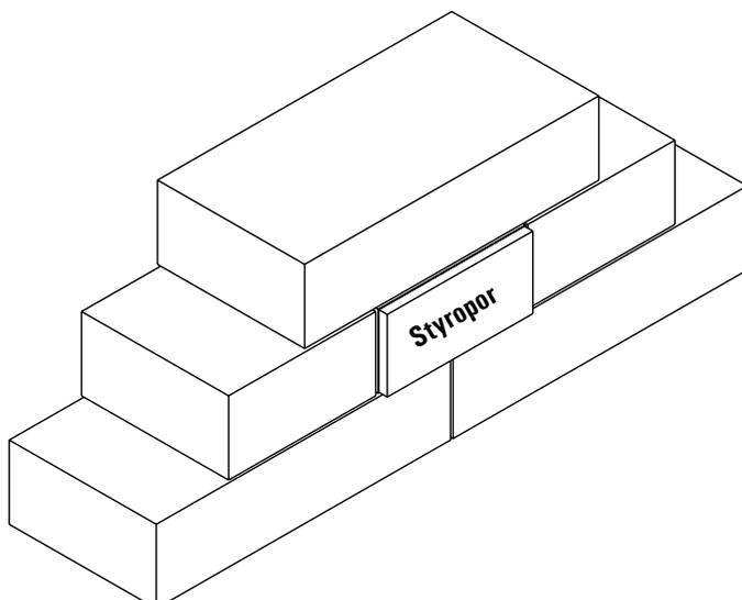
Bei freistehender Mauer **muss** die rückseitige Öffnung mit einem Halbstein oder einem zweiten FOCUS Modul geschlossen werden !
